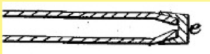
1847蒸汽机车锅炉上的易熔插头。Cap “e” 融化并释放蒸汽
