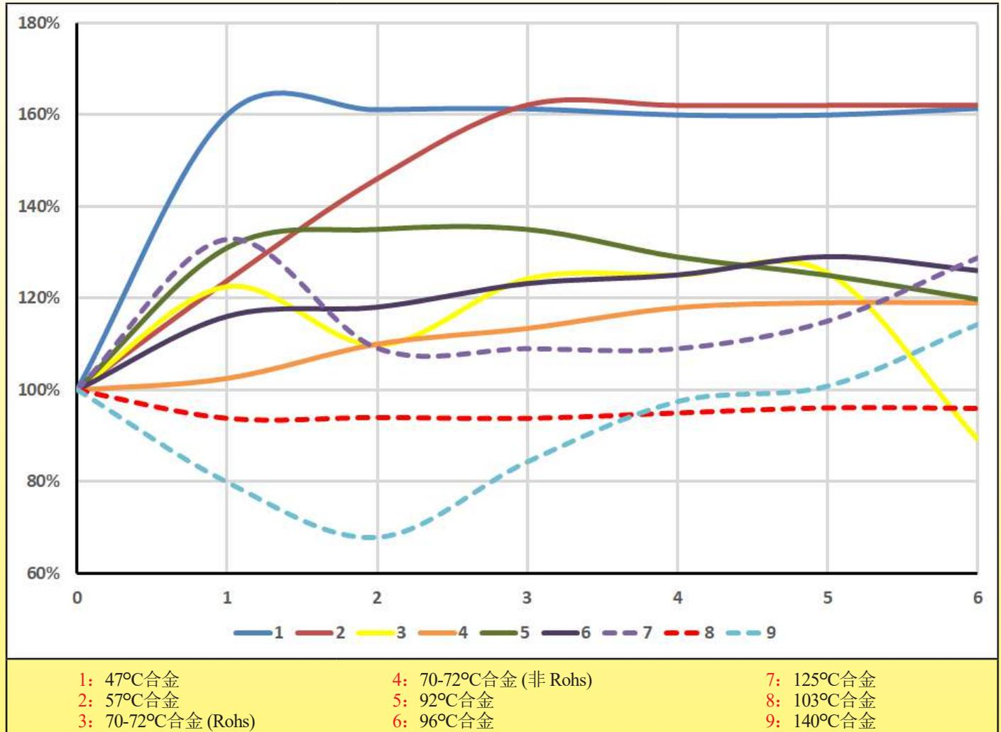
以上的曲线图代表了在焊接后立即进行测量的数值的%, 焊接测试的样品在超过7周的电阻变化, 使用了一个225平方毫米的表面焊接, 用各种各样的易熔合金制成。
