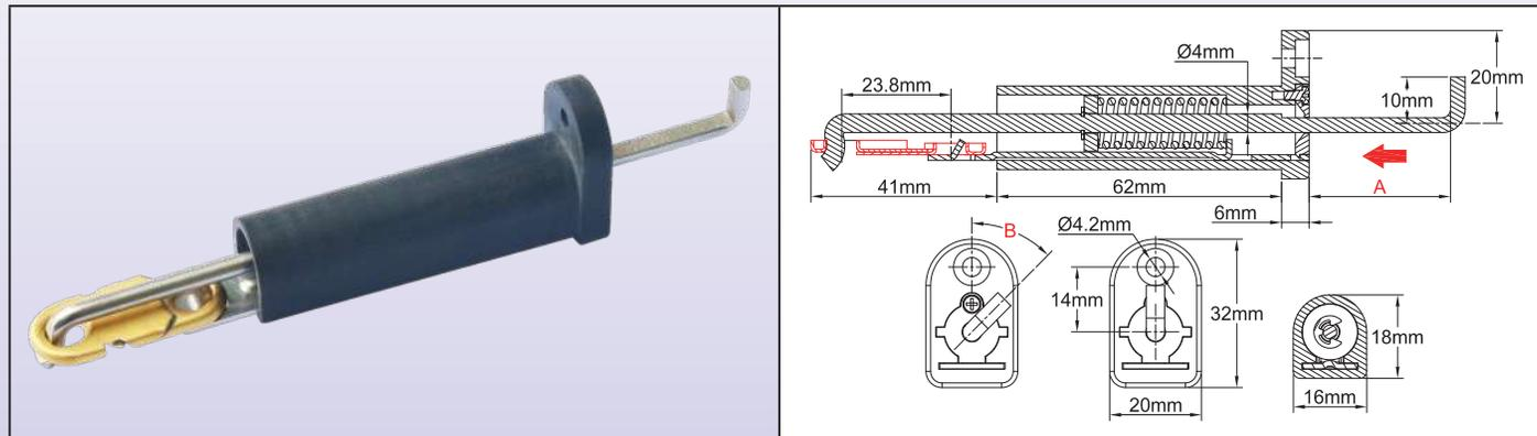
这些机械的热驱动装置用于关闭在通风管道上使用的防火阀。其大的操作力解开弹簧以驱动阻尼器。不需要电源，这些设备特别简单可靠。所有的防火阀均被强制性要求必须符合 NF-S 61.937 标准。它们产生的力与共晶保险扣相兼容，焊接表面等于或大于 200mm<sup>2</sup>\*。但是，某些当地法规可能会要求定期更换保险扣或热驱动器。
