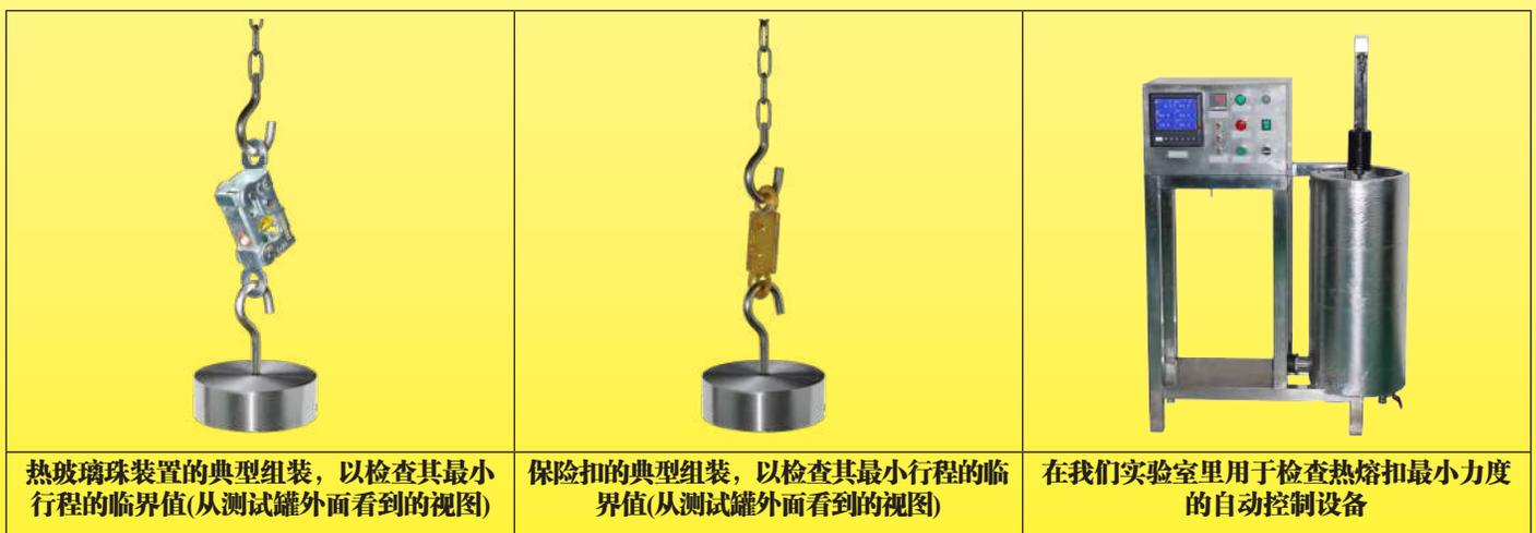
热玻璃珠装置的典型组装，以检查其最小行程的临界值(从测试罐外面看到的视图)
