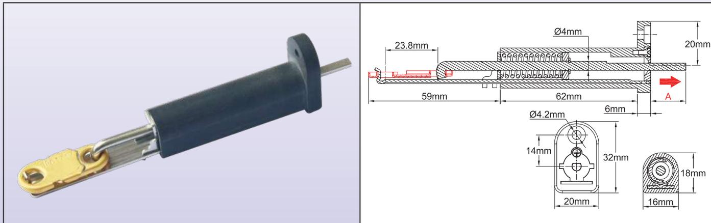
这些机械的热驱动装置用于关闭在通风管道上使用的防火阀。其大的操作力解开弹簧以驱动阻尼器。不需要电源，这些设备特别简单可靠。所有的防火阀均被强制性要求必须符合 NF-S 61.937 标准。它们产生的力与共晶保险扣相兼容，焊接表面等于或大于 200mm<sup>2</sup>\*。但是，某些当地法规可能会要求定期更换保险扣或热驱动器。
