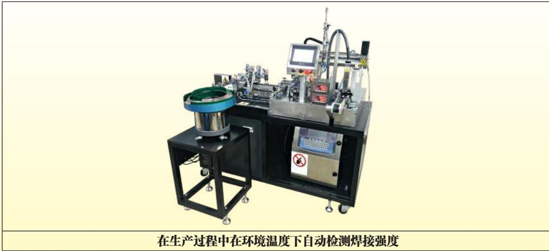
在生产过程中在环境温度下自动检测焊接强度
