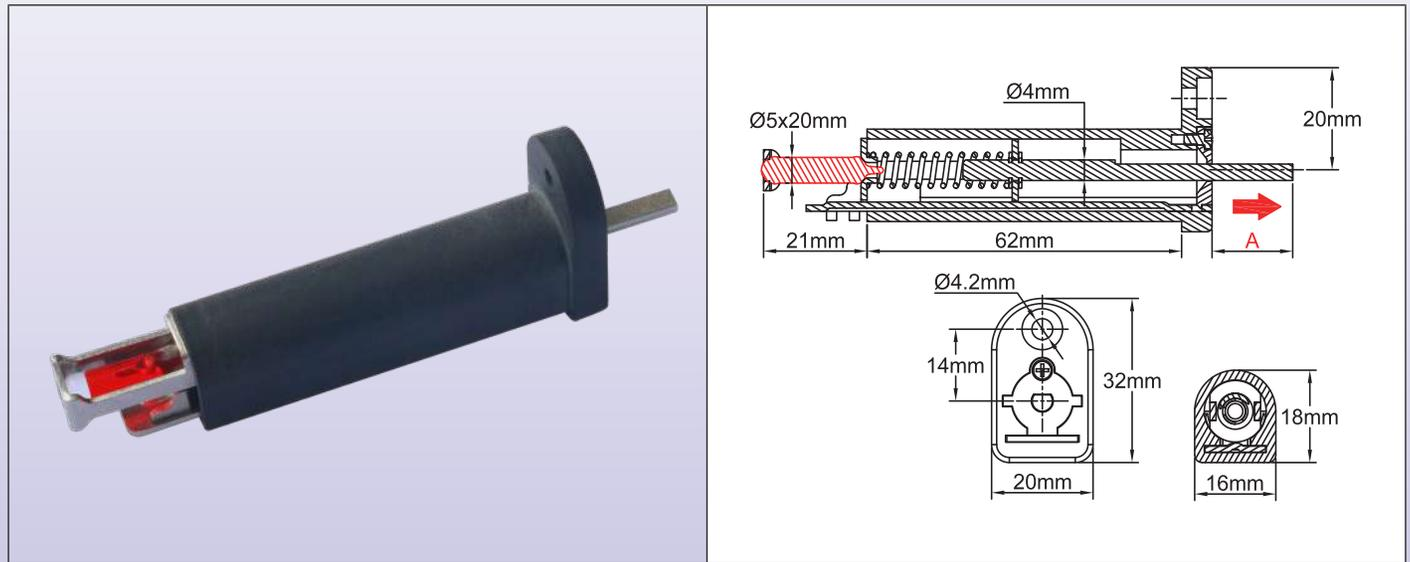
这些机械的热驱动装置用于关闭在通风管道上使用的防火阀。其大的操作力解开弹簧以驱动阻尼器。不需要电源，这些设备特别简单可靠。所有的防火阀均被强制性要求必须符合 NF-S 61.937 标准。由于感温玻璃珠不会发生蠕变，因此无需定期更换。
